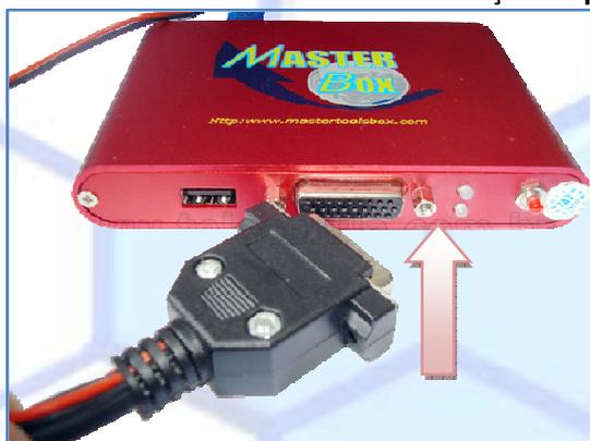
Figura 31 - Conecte o cabo extensor de alimentação
