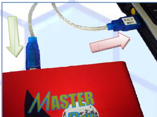
Figura 6 - Conecte a MASTER BOX em seu computador
